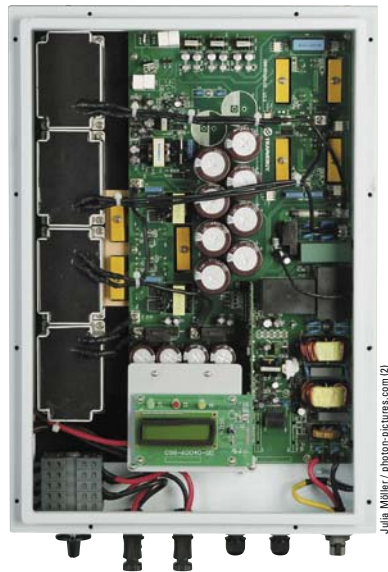
▲ Schlicht von außen, unkritische Temperaturen im Inneren: Die sichtbaren Bauteile im Trannergy PVI4600TL erwärmen sich nicht über Gebühr. Am wärmsten wird die netzseitige Sicherung mit 70,5 Grad Celsius.
